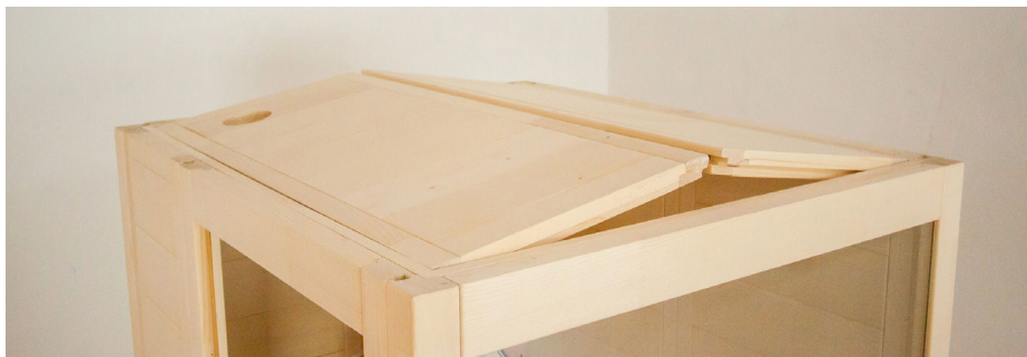
Fig. 15: Fissaggio degli elementi tetto
