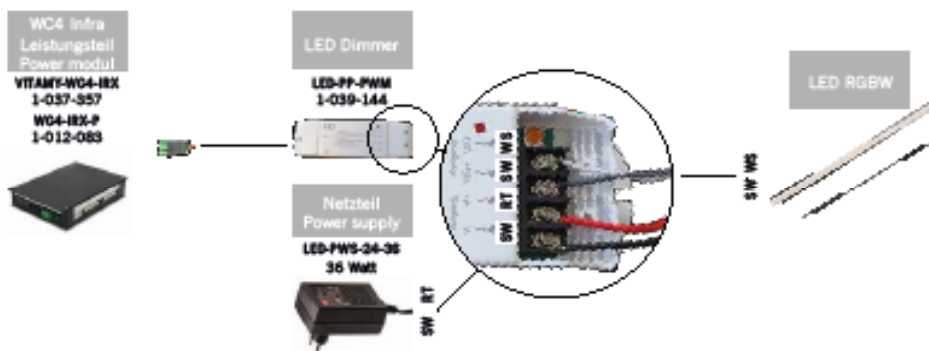
Fig. 28: Conexão da tira LED ao comando
