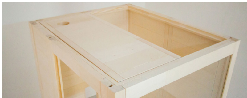
Fig. 14 : Insertion de l'élément de toit avant
