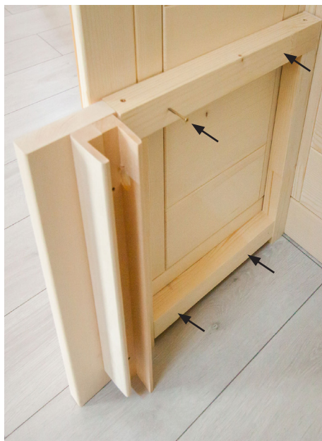
Fig. 18: Montare i supporti della panca
