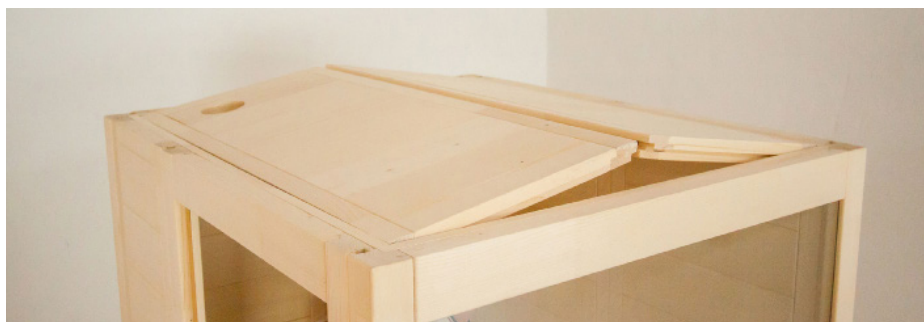
Fig. 15 : Fixation des éléments de toit
